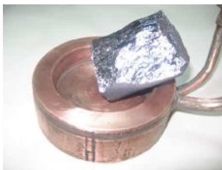
Рис. 2. Внешний вид медного водоохлаждаемого тигля с исходным металлургическим кремнием
