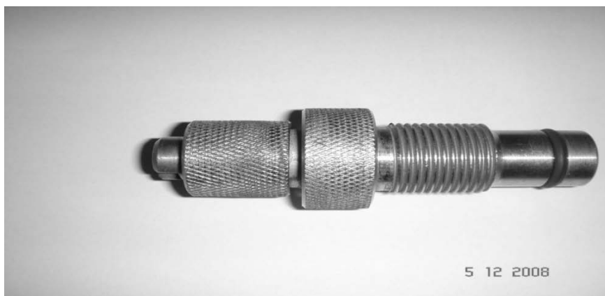
Рис. 4.5. Дослідний зразок універсального соплотримача
