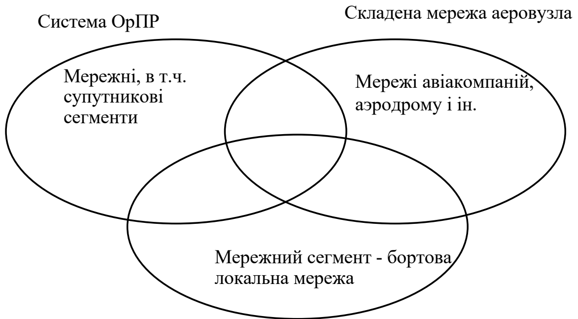
Рис. 3.7. Схема взаємозв'язку і взаємодії сегментів складеної мережі аеровузла і зовнішніх інформаційних мереж
