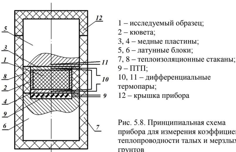
Рис. 5.8. Принципиальная схема прибора для измерения коэффициента теплопроводности талых и мерзлых грунтов
