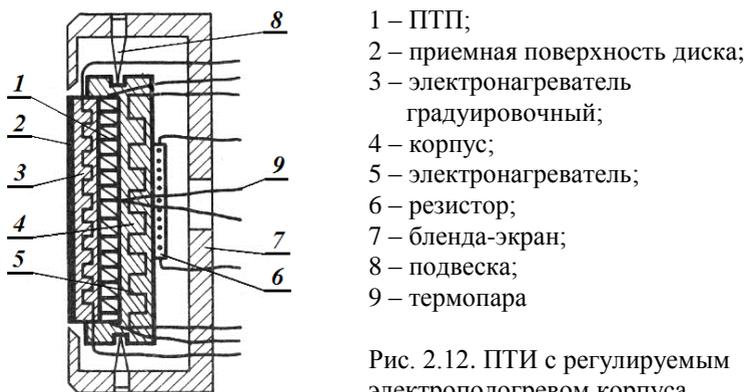
Рис. 2.12. ПТИ с регулируемым электроподогревом корпуса
