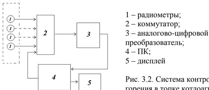
Рис. 3.2. Система контроля процесса горения в топке котлоагрегата
