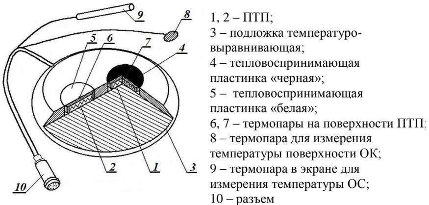
Рис. 1.11. Схема конструкции устройства модели РКТП
