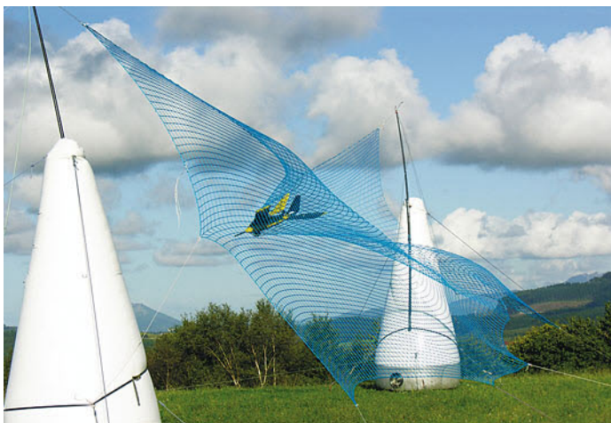
Рисунок 1.20 – Посадка БПС Fulmar у сітку ( http://www.laserlocation.ru/catalog/aircraft/UAV/3435/ )
