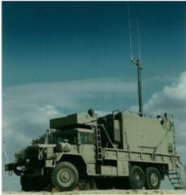
Рисунок 1.29 – Мобільна НСК, розташована у спеціальному кузові-фургоні автомобіля ( http://bp-la.ru/bla-hermes-450/ )
