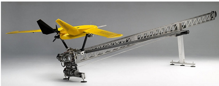
Рисунок 1.15 – Стартовий пристрій БПС Fulmar ( http://www.laserlocation.ru/catalog/aircraft/UAV/3435/ )
