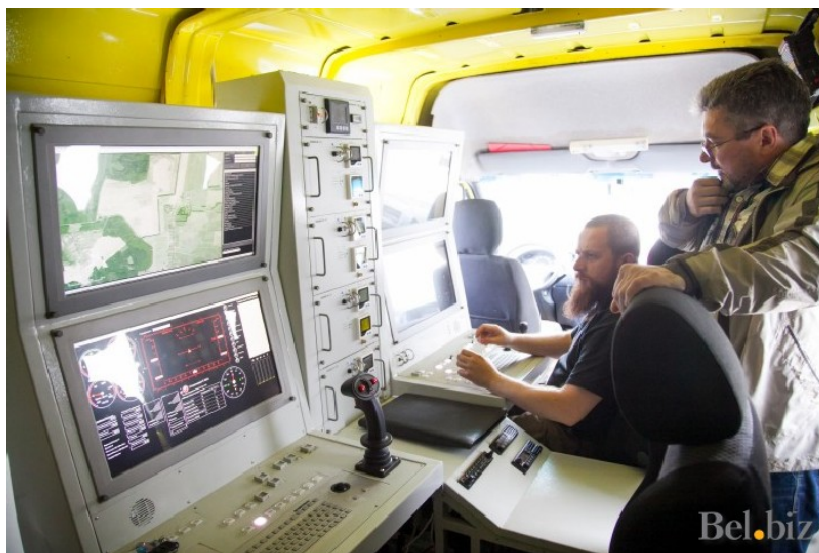
Рисунок 1.28 – Мобільна НСК, змонтована у кузові мікроавтобуса http://www.indelauav.com/press_17102014.html
