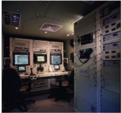
Рисунок 1.29 – Мобільна НСК, розташована у спеціальному кузові-фургоні автомобіля ( http://bp-la.ru/bla-hermes-450/ )
