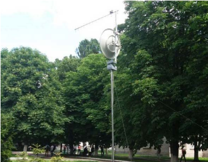
Рисунок 1.4 – Загальний вигляд антенної та поворотної систем наземної станції керування БПС М-6-3 «Жайвір» (НВ ЦБА «Віраж» НАУ, Україна)
