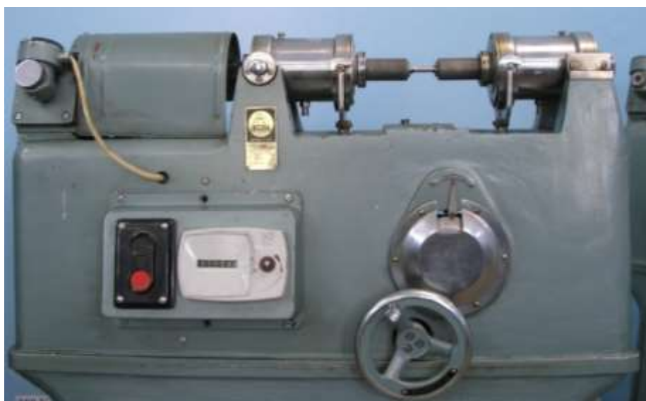
Рис. 2.12 Зовнішній вигляд установки для випробувань на втому
