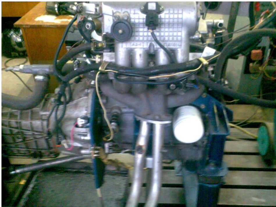
Рисунок 4 – Загальний вигляд двигуна MeM3-307.1 з коробкою передач
