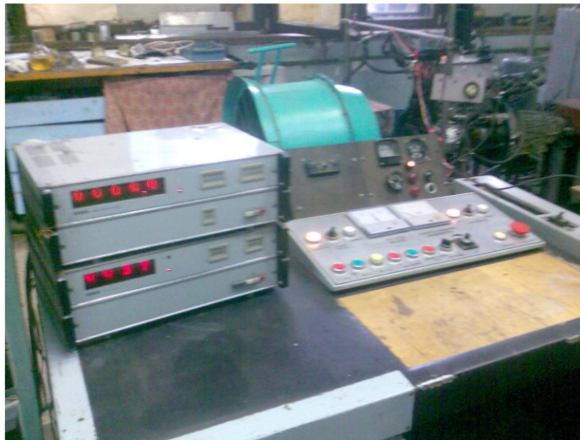
Рисунок 2 – Пульт керування випробувальним моторним стендом
