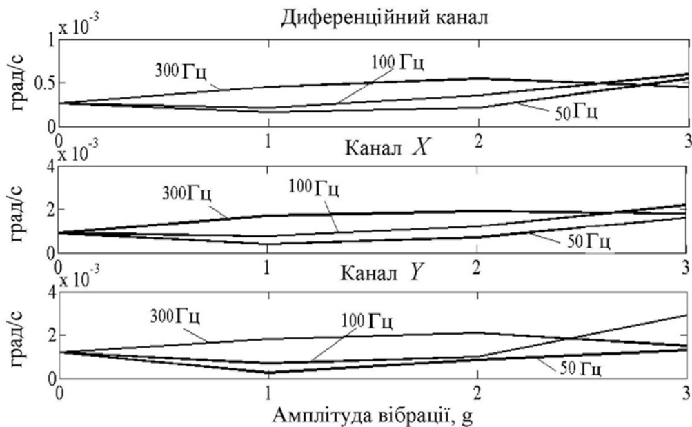
Рис.4.22. Нестабільність зміщення нуля диференційного ВДКШ при дії синусоїдальної вібрації різних частот і амплітуд
