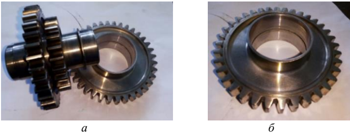
Рис. 2. Деталі агрегатів двигуна Д-36: а – шестерня приводу маслонасоса; б – шестерня приводу гідронасоса
