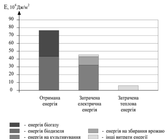
Рис. 11. Енергетичний баланс під час культивування мікроводоростей у відкритих фотобіореакторах в умовах України
