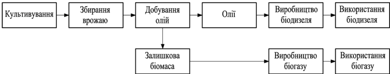
Рис. 9. Схема виробництва біопалива з мікроводоростей
