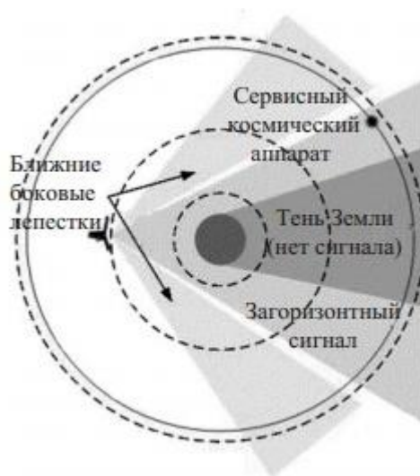
Рис. 5.36. Основний та бокові пелюстки діаграми напрямленості антени навігаційного супутника
