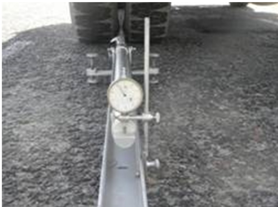
Рис. 4.7. Зняття показників приладу після відновлення пружніх деформацій.
