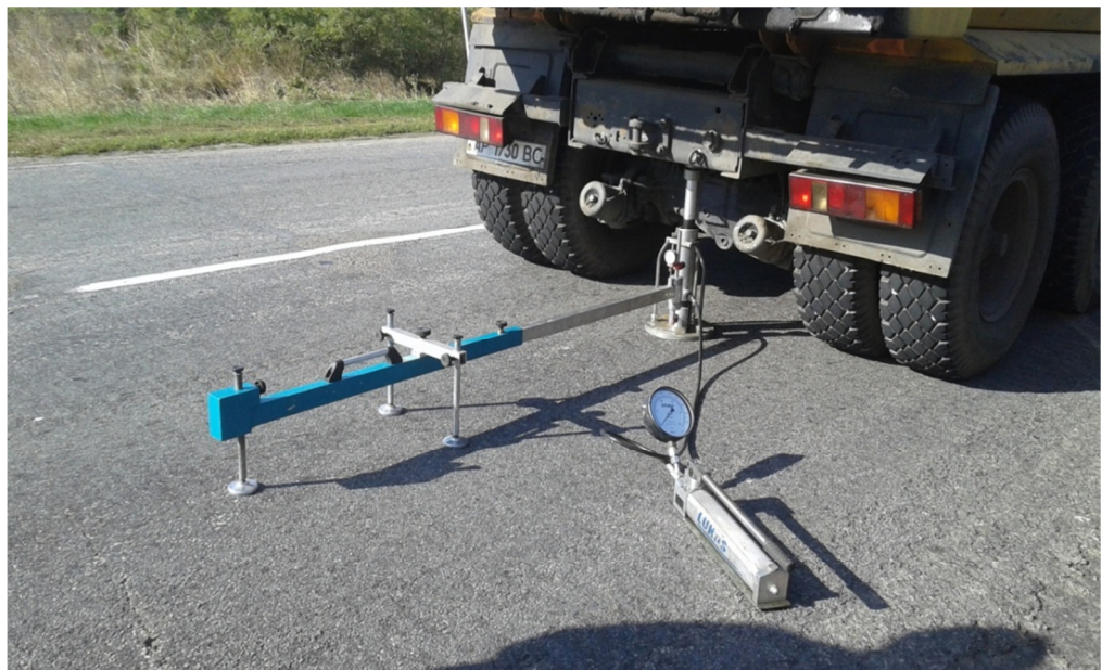
Рисунок 4.6. Розміщення підп'ятника прогиноміра КП-204 під спареним колесом вантажівки
