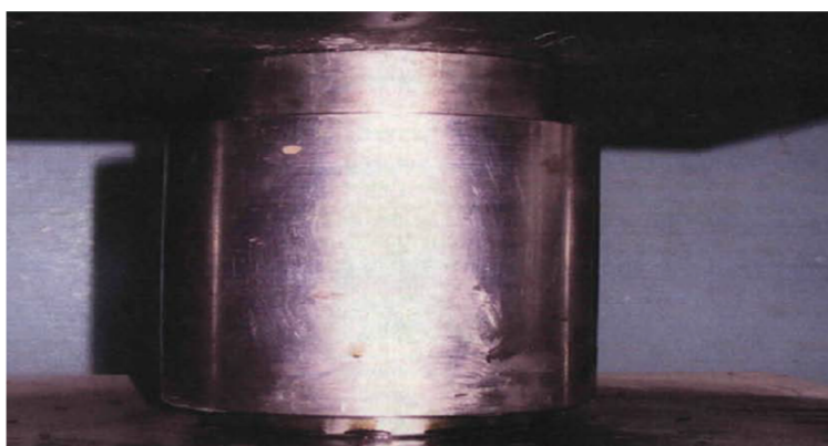
Рис. 3.3. Робочий момент виготовлення асфальтобетонного зразка
