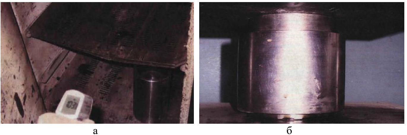
Рис. 3. Робочі моменти нагрівання сталевій формі та виготовлення асфальтобетонного зразка: а – нагрівання сталевій формі; б – виготовлення асфальтобетонного зразка
