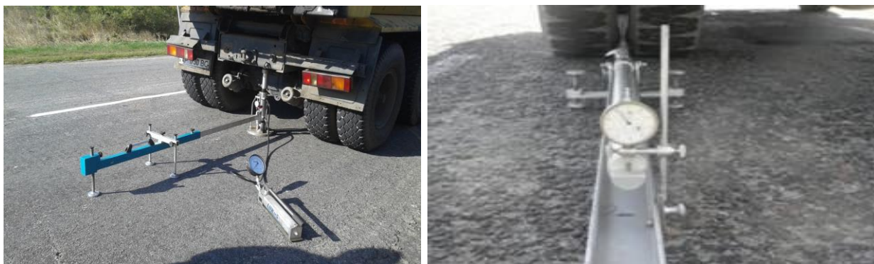
Рис. 9. Визначення міцності дорожнього одягу за допомогою жорсткого штампу від колеса розрахункового автомобіля МАЗ-503 А з використанням важільного прогиноміру КП-204: а – розміщення підп'ятника прогиноміра КП-204 під спареним колесом вантажівки; б – зняття показників приладу після відновлення пружних деформацій
