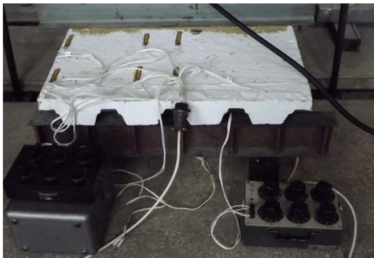
Рис. 5. Розміщення електротензорезисторів при дослідженні елементів плит по профнастилу
