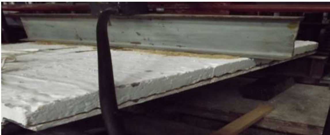
Рис. 3.27. Момент відриву профнастилу від бетонного блоку в зразка П3
