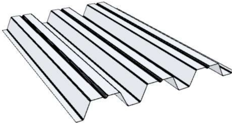
Рис. 4.1. Тривимірна геометрична модель профільованого настилу Н-85
