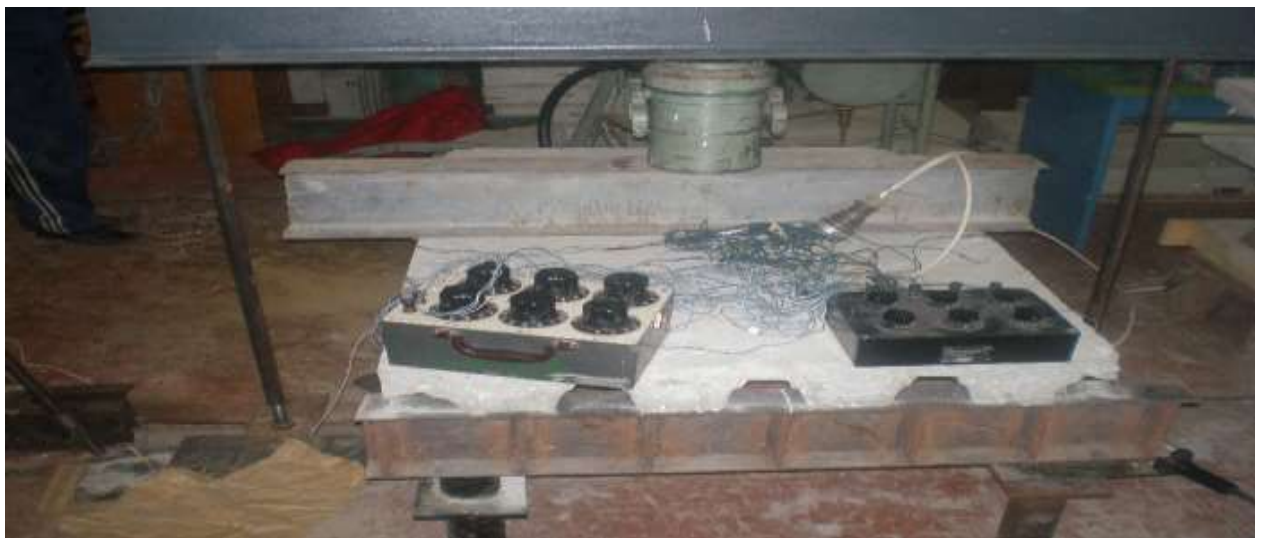
Рис. 3.3. Випробування елемента плит перекриття по профнастилу
