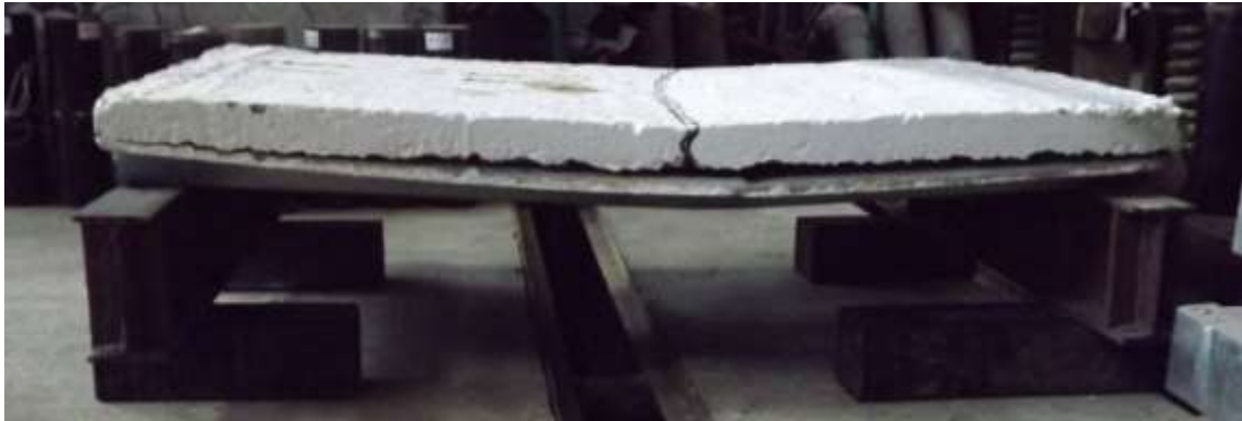
Рис. 3.31. Характер деформування та руйнування конструкції
