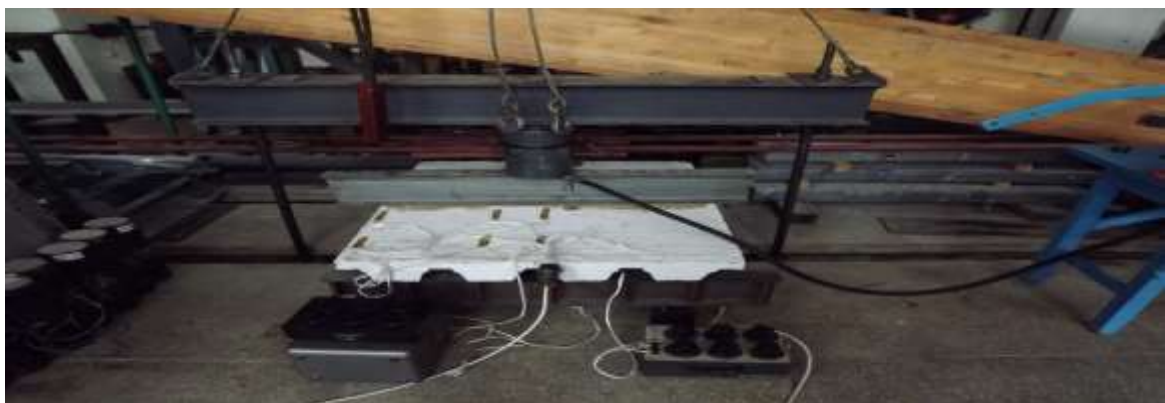
Рис. 3.7. Розміщення електротензорезисторів при дослідженні елементів плит по профнастилу
