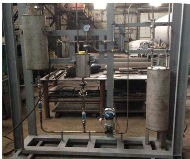
Рис. 3. Фото установки для кавітаційного перероблення вуглеводнів в компоненти моторних палив
