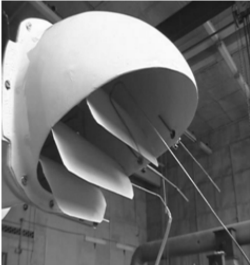
Рисунок 11 — Дослідний зразок екранно-вихлопного пристрою ежекторного типу із напрямними лопатками на виході з камери змішування
