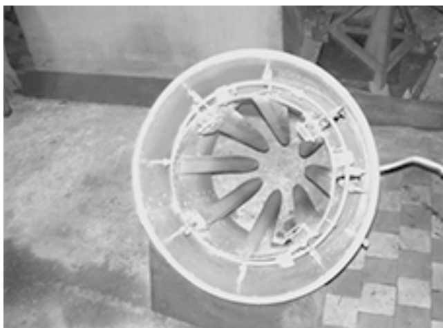
Рисунок 10 — Дослідний зразок ежектора з пелюстками на вході до камери змішування
