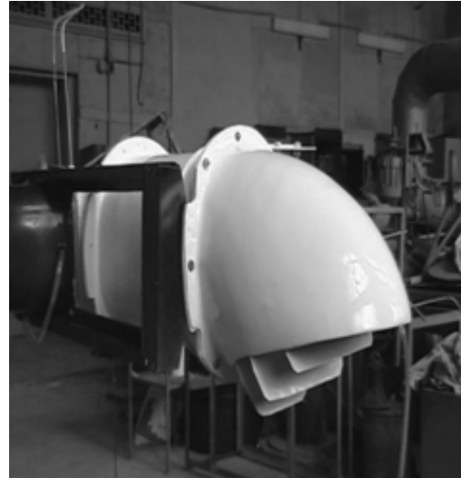
Рисунок 11 — Дослідний зразок екранно-вихлопного пристрою ежекторного типу із напрямними лопатками на виході з камери змішування
