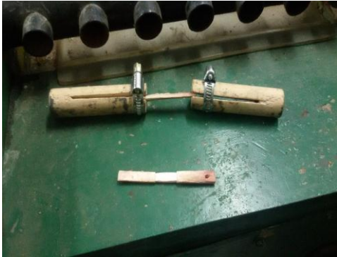
Рис. 10.4. Загальний вигляд установки для втомних досліджень плоских зразків
