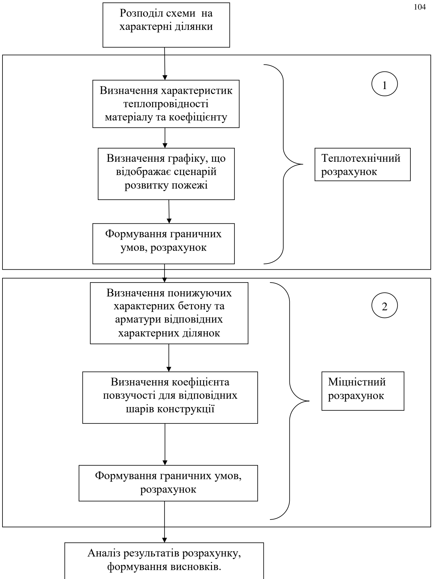
Рис.5.14. Лінійна блок-схема розрахунку конструкцій на вогнестійкість
