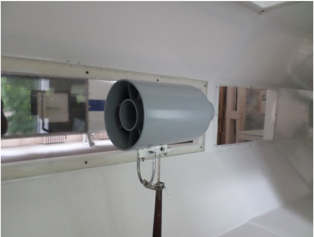
Рис.3.5. Установка моделі мотогондолі в робочій частині аеродинамічної труби АТ-1
