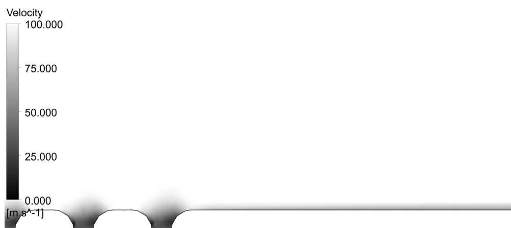
Рис. 4.10. Примежовий шар на поверхні циліндричної мотогондоли з відсмоктуванням (отвори з прямокутними вхідними кромками)
