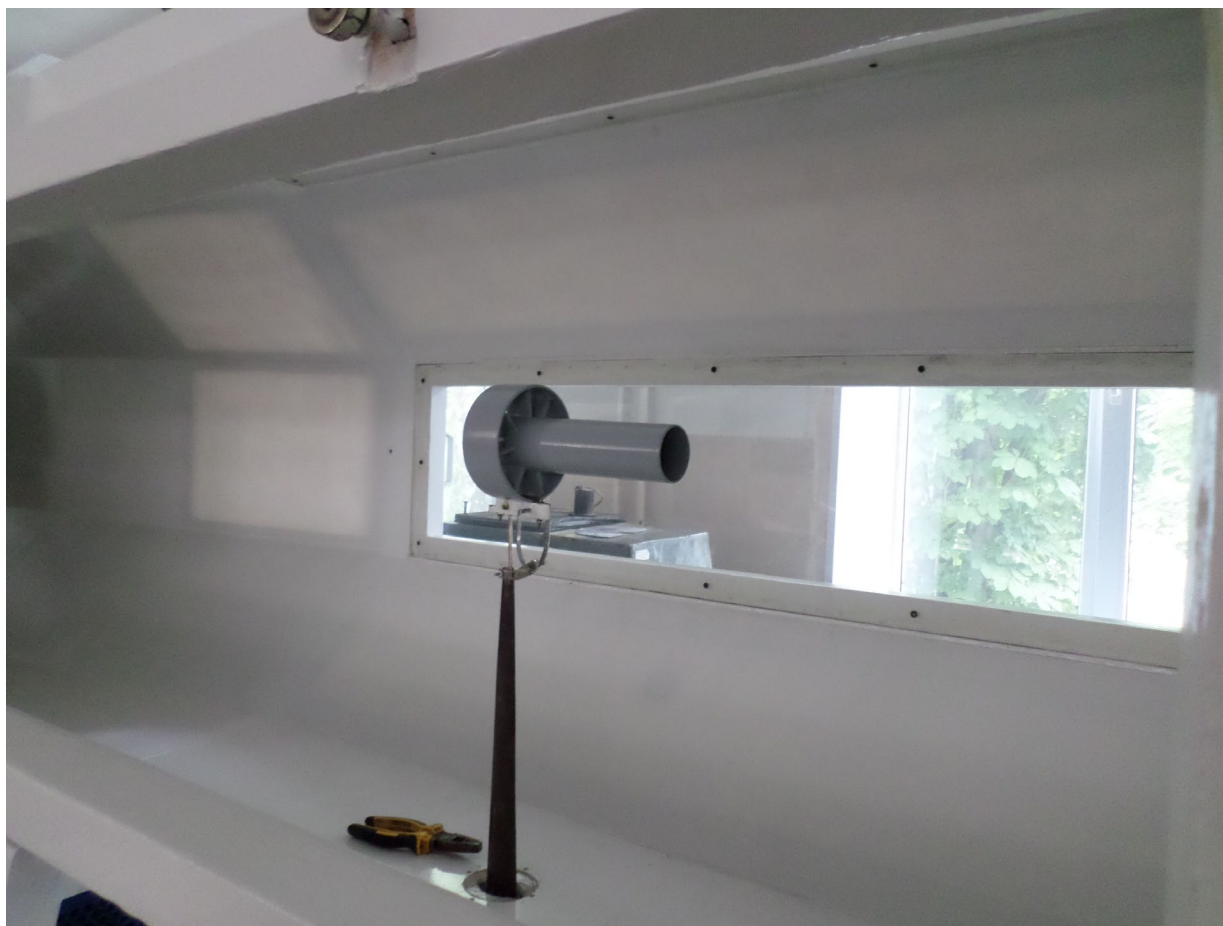
Рис.3.6. Установка моделі ступінчастої мотогондолої в робочій частині аеродинамічної труби АТ-1
