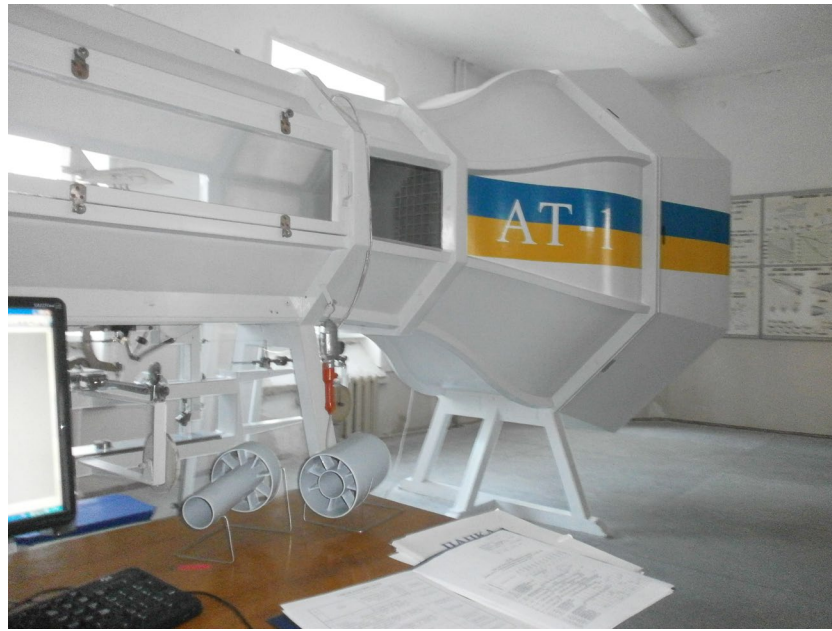
Рис.3.2. Експериментальна установка для аеродинамічних досліджень моделей мотогондол авіаційних силових установок АТ-1
