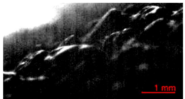
Рис. 2.17 Структура поверхні зледеніння при -15.0^{\circ}\text{C} (на віддаленні від лінії гальмування близько 10% хорди крила)
