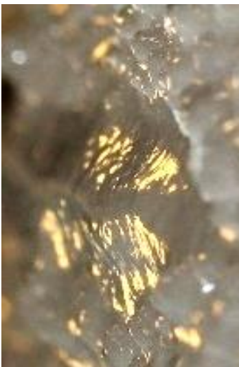
Рис. 2.22 (продовження) Структура криги, що утворилася на поверхні профілю при температурі -10.0^{\circ}\text{C} , LWC : а) – 1.1 , б) – 2/\text{м}^3 , в) – 1.1 2/\text{м}^3 , в) – 1.1 2/\text{м}^3
