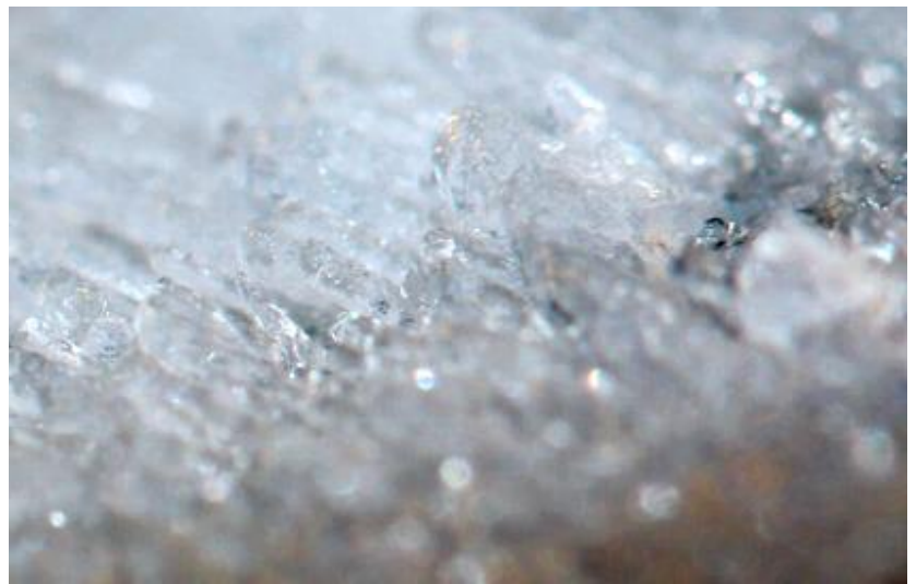
Рис. 2.22 Структура криги, що утворилася на поверхні профілю при температурі -10.0^{\circ}\text{C} , LWC : а) – 1.1 , б) – 2/\text{м}^3 , в) – 1.1 2/\text{м}^3 , в) – 1.1 2/\text{м}^3
