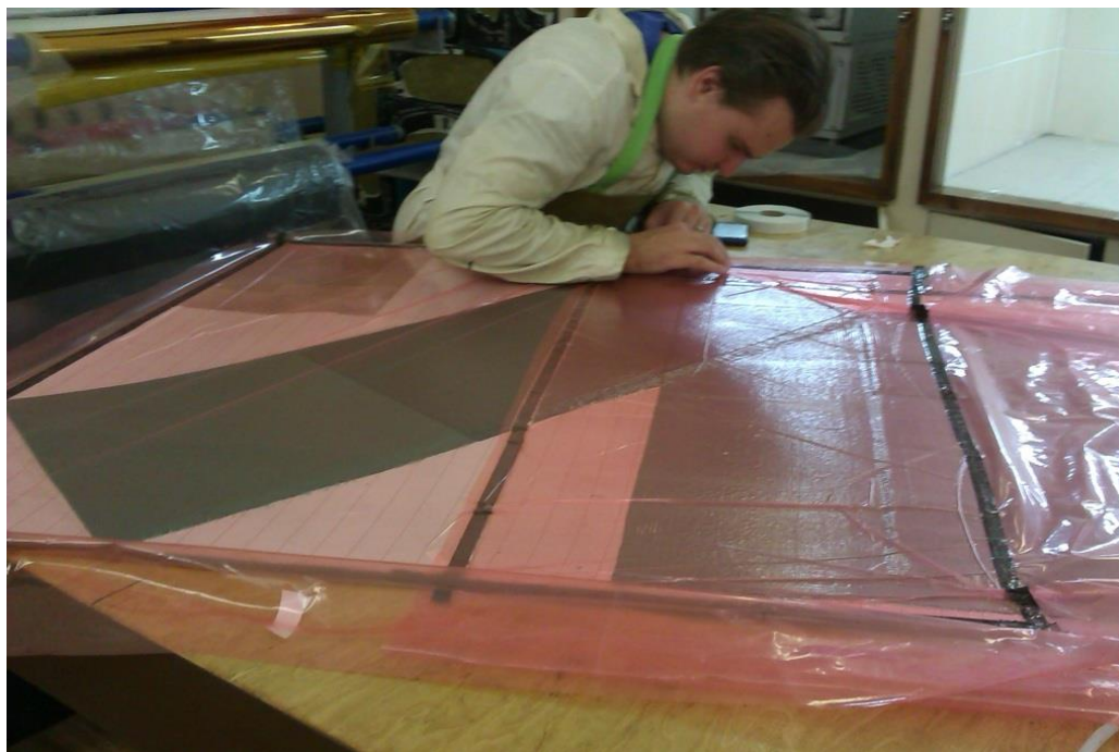
Рис. 2.10 Перевірка герметичності вакуумного мішка
