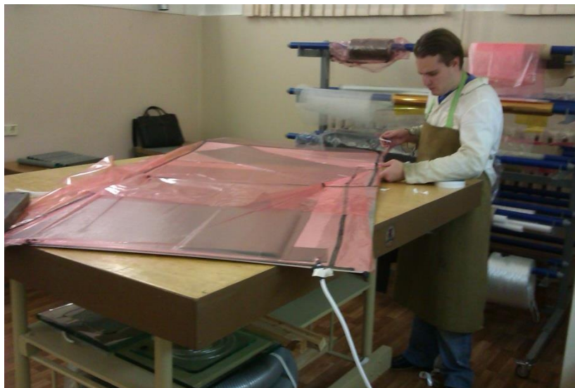
Рис. 2.9 Виготовлення вакуумного мішка
