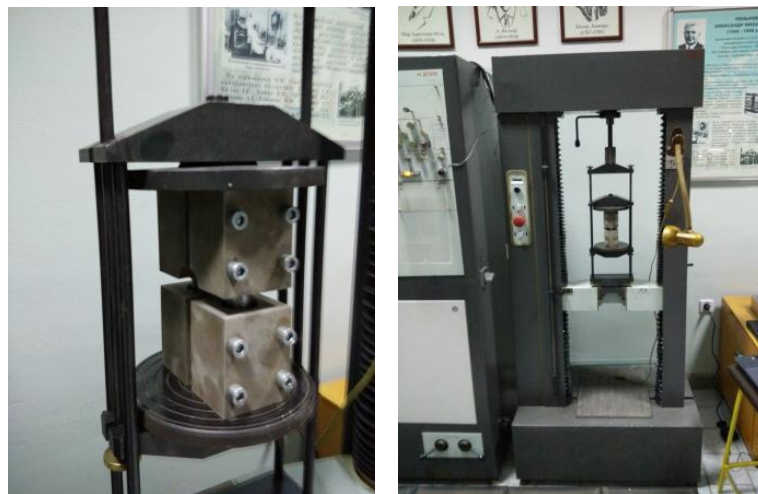
Рис. 2.16 Пристосування із зразком у випробувальній установці FP-10
