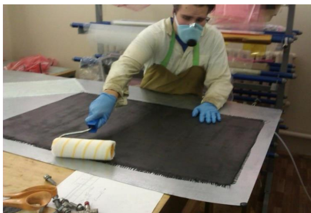
Рис. 2.8 Викладення препрегу а) викладення на форму; б) прикочування шарів
