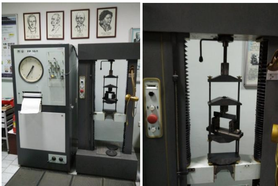
Рис. 2.18 Випробувальна машина FP-10 із устаткуванням для випробувань на 3-ох точковий згин
