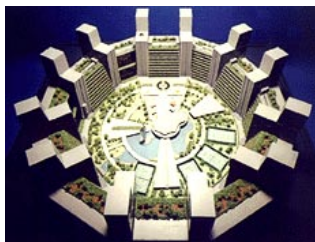
Рис.1.85. Потужні колони, що оточують кожен чашу-мікрорайон, слугують опорою для наступної чаші
