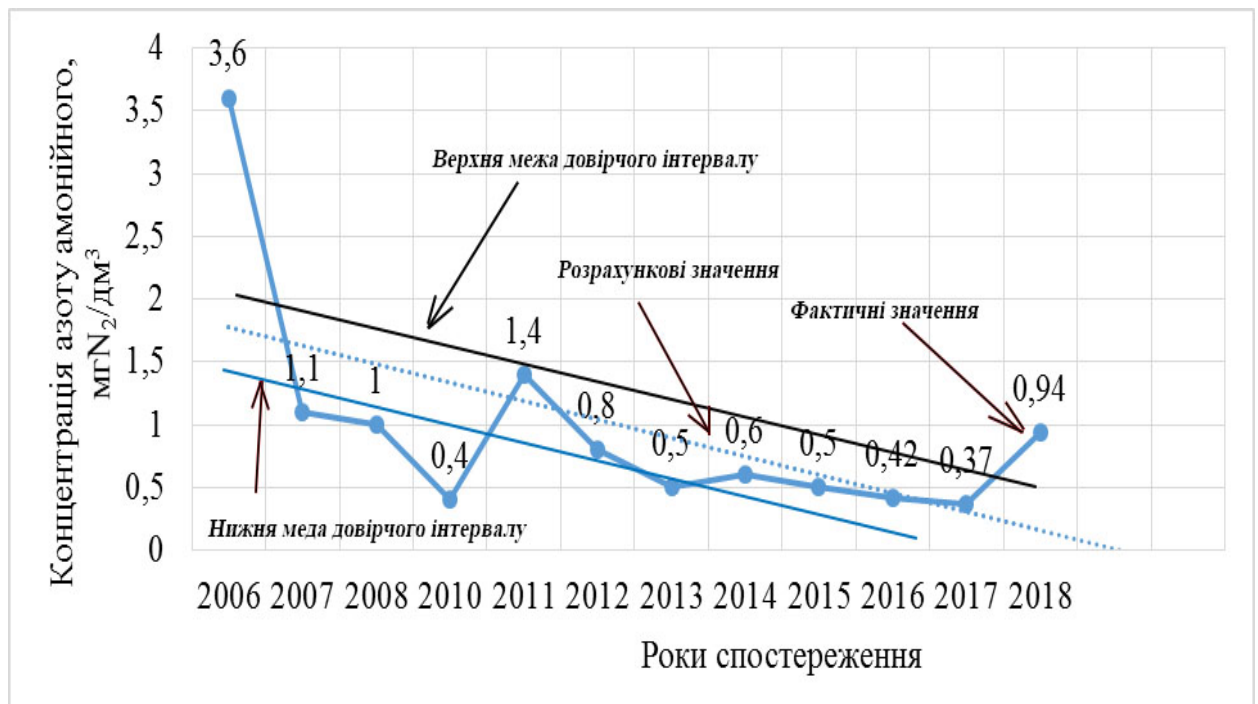
Рис.3.9. Прогноз параметру азоту амонійного р. Ірпінь з довіреними межами для гирлової ділянки гідростора в с. Козаровичі
