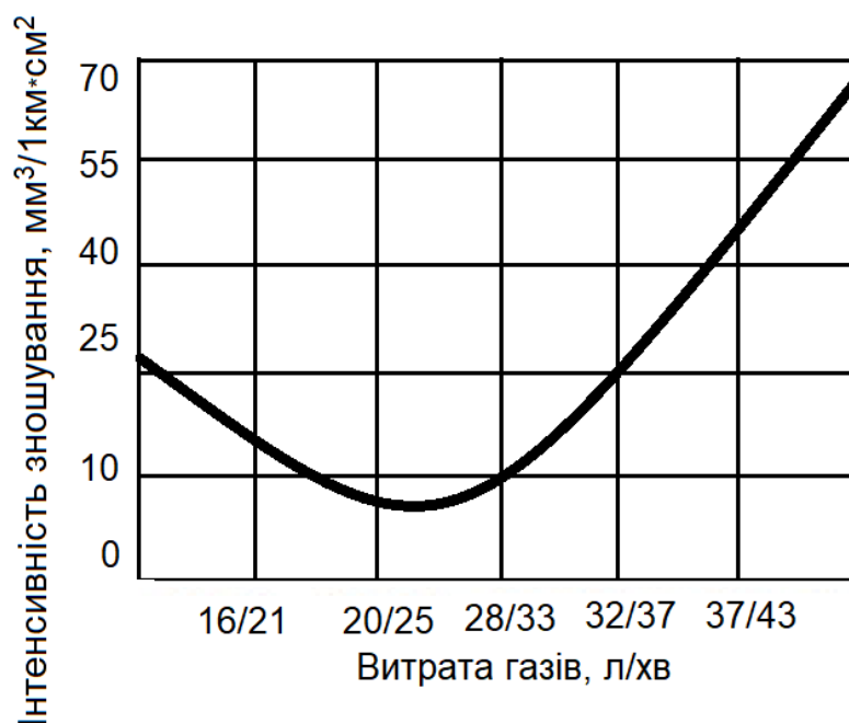
Рис.3.10. Залежність інтенсивності зносу покриттів Zr-Al-V від витрати газової суміші при напиланні.
