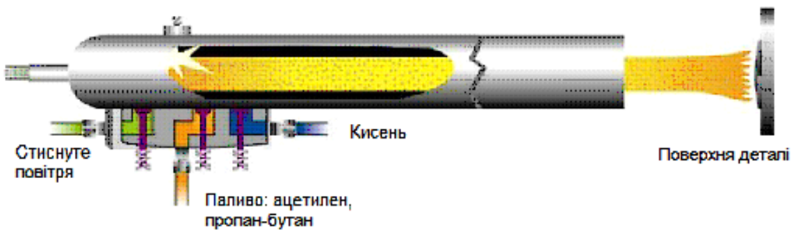
Рис. 2.4. Загальний вигляд установки для детонаційно-газового наплення (а) і принципова схема (б).
