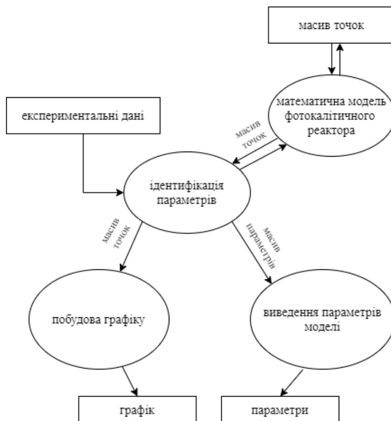
Рис.3.3 Схема програмного забезпечення та потоки даних
