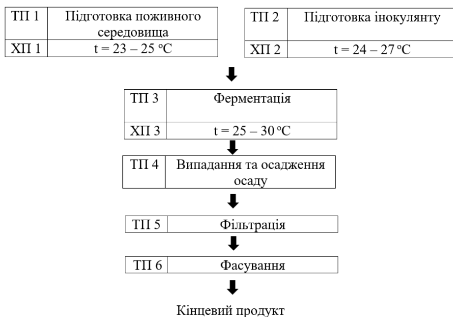
Рис 2.1. Технологічна схема виробництва квасу за розробленою технологією
