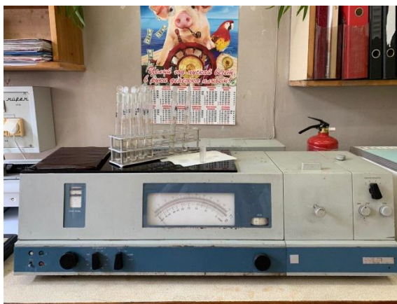
Рис. 3.15. Вимірювання оптичної густини на фотоелектроколориметрі (СФ – 26. ЛОМО)
