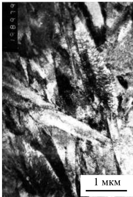
Рис. 3.14. Мікроструктура пакетного (а) та голчастого (б) мартенситу в загартованій від 860 °С сталі 40Х.
