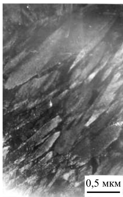
Рис. 3.37. Мікроструктура сталі 40ХНМ після гартування від 860 °С (а, б) та 1050 °С (в).
