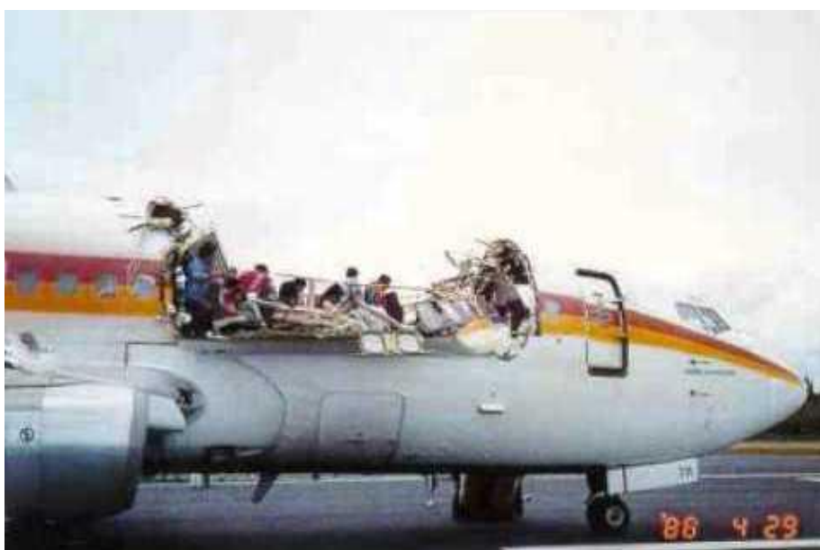
Рис. 1.1. Руйнування фюзеляжу літака Boeing 737-200 внаслідок багатоосередкового пошкодження
