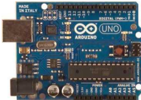
Рисунок 3.1 - Зовнішній вигляд Arduino Uno
