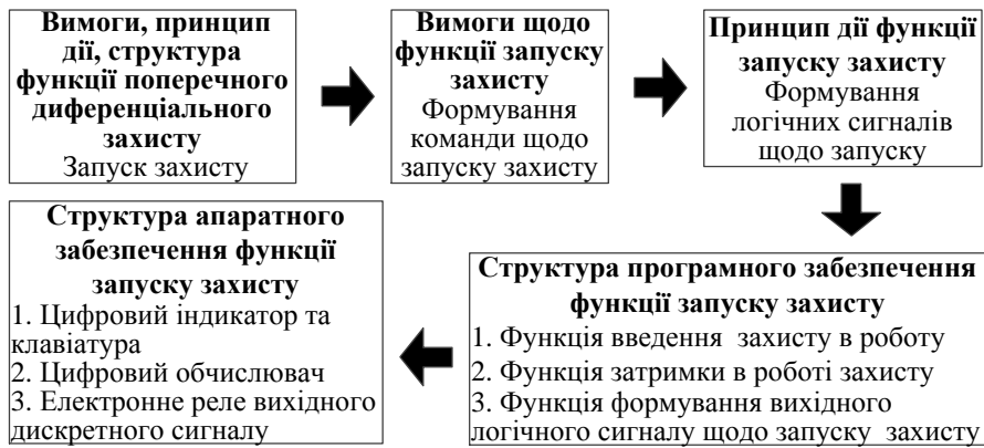
Рисунок 6.8 – Каузальний ланцюг знань з визначення вимог, принципу дії та структури програмного й апаратного забезпечення функції запуску захисту
