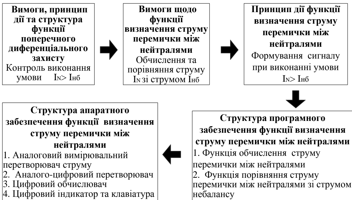
Рисунок 6.6 – Каузальний ланцюг знань з визначення вимог, принципу дії й структури програмного та апаратного забезпечення функції визначення струму перемички між нейтраліями
