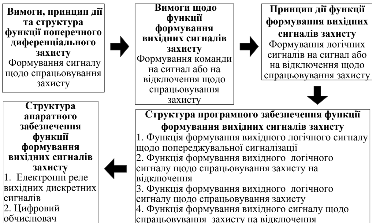
Рисунок 6.7 – Каузальний ланцюг знань з визначення вимог, принципу дії й структури програмного та апаратного забезпечення функції формування вихідних сигналів захисту
