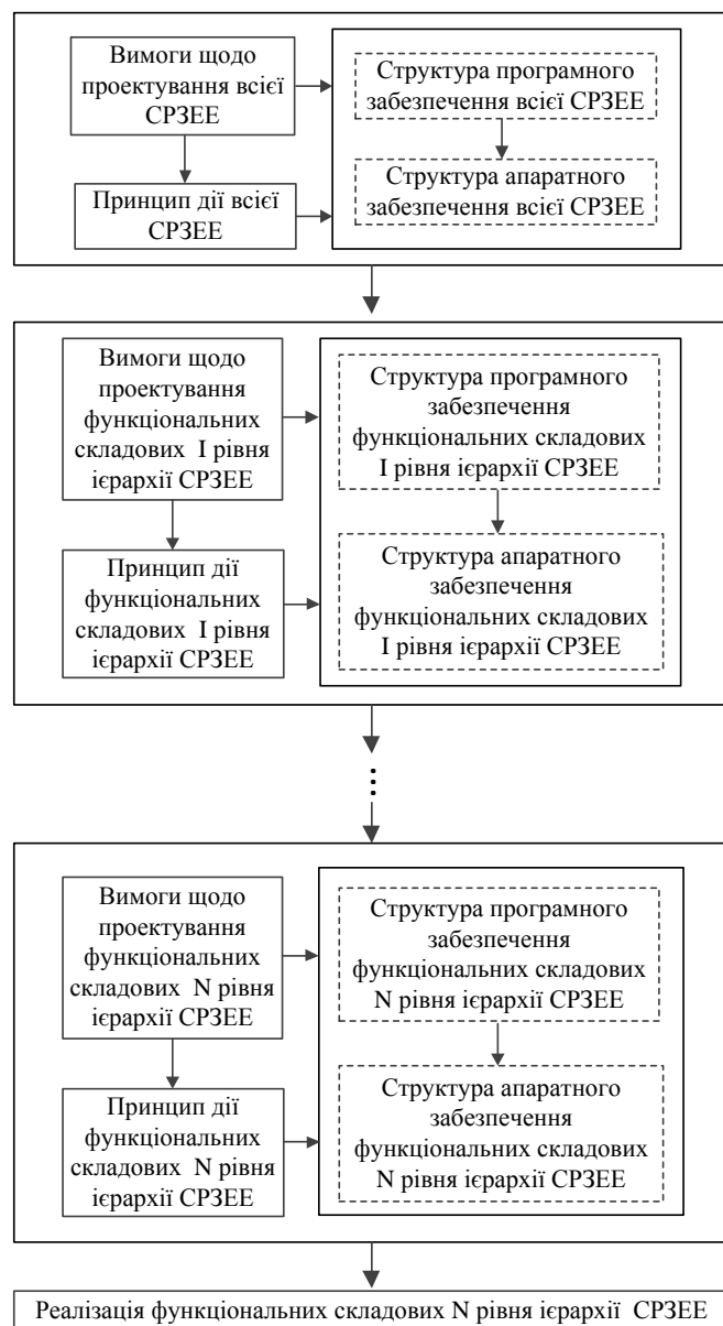
Рисунок 6.9 – Узагальнений каузальний ланцюг знань при проектуванні системи релейного захисту елемента енергосистеми
