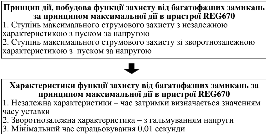
Рисунок 6.43 – Каузальний ланцюг знань з визначення характеристик функції від багатофазних коротких замикань за принципом максимальної дії в пристрої REG670
