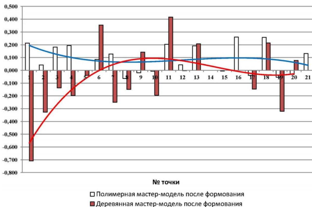
Рисунок 9 - Порівняння відхилень геометричних розмірів майстер-моделей після формування оснащення
