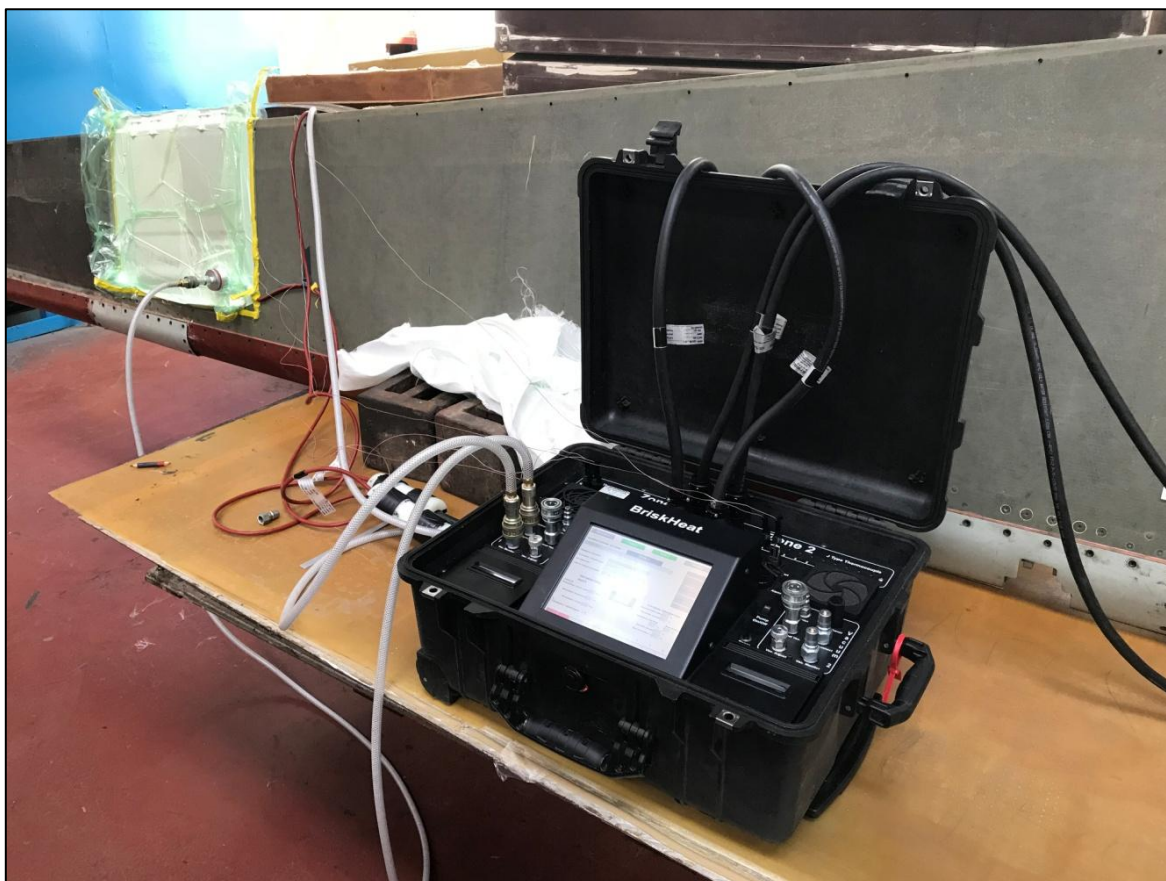
Рисунок 16 - Ремонт ушкодженої зони керма висоти літака Ан-178 с застосуванням АРК
