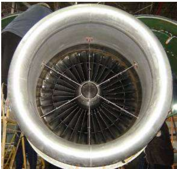
Рисунок 2.2 – Установлення гребінок приймачів тиску у повітрозбірнику ( a ) і соплі вентиляторного контуру двигуна ( б )
