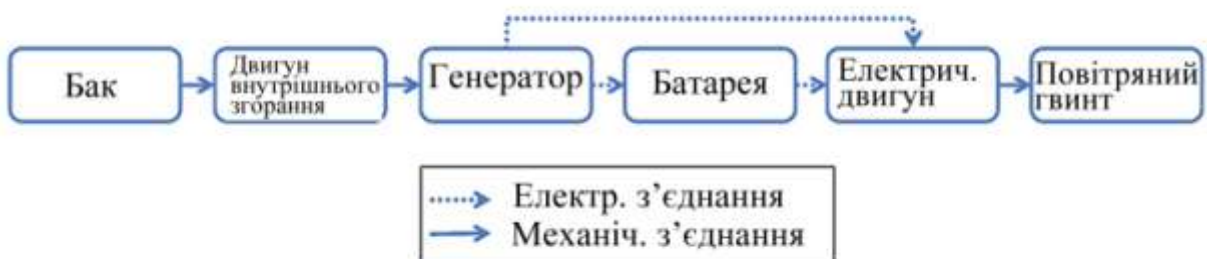
Рисунок 5.39 – Приклад використання послідовної схеми гібридної маршової силової установки
