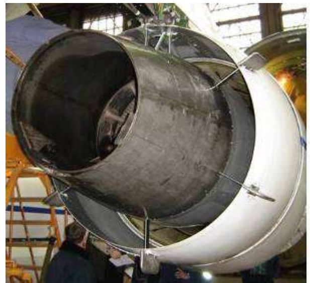
Рисунок 2.2 – Установлення гребінок приймачів тиску у повітрозбірнику ( a ) і соплі вентиляторного контуру двигуна ( б )
