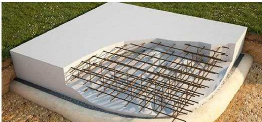
Рис. 5.4. Схема монтажу монолітного перекриття
