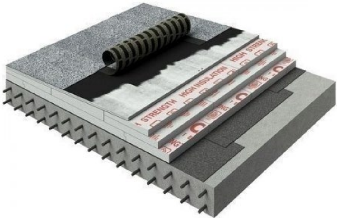
Рис. 5.1. Покрівля ТехноНІКОЛЬ CARBON PROF 250 SLOPE 8,3%
