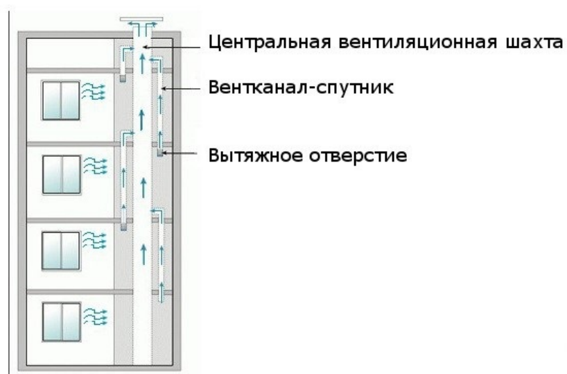
Рис.5.14. Схема витяжної вентиляції багатоповерхового житлового будинку
