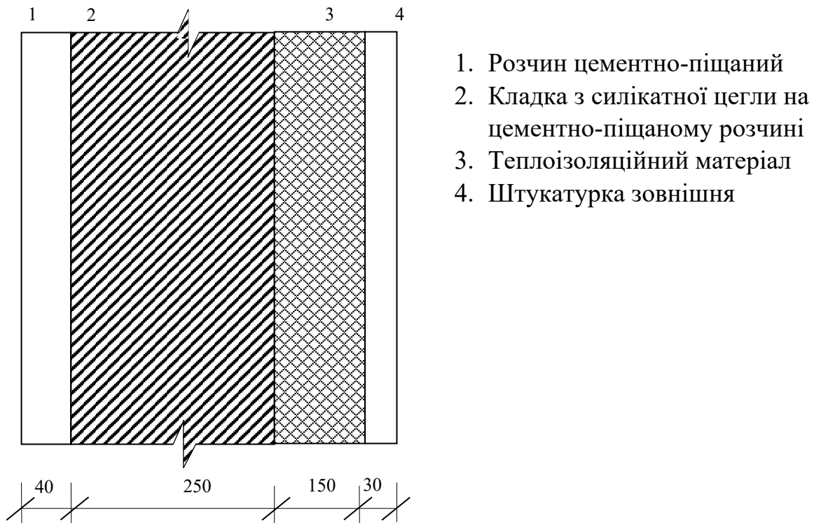
Рис. 5.5. Структура зовнішніх стін
