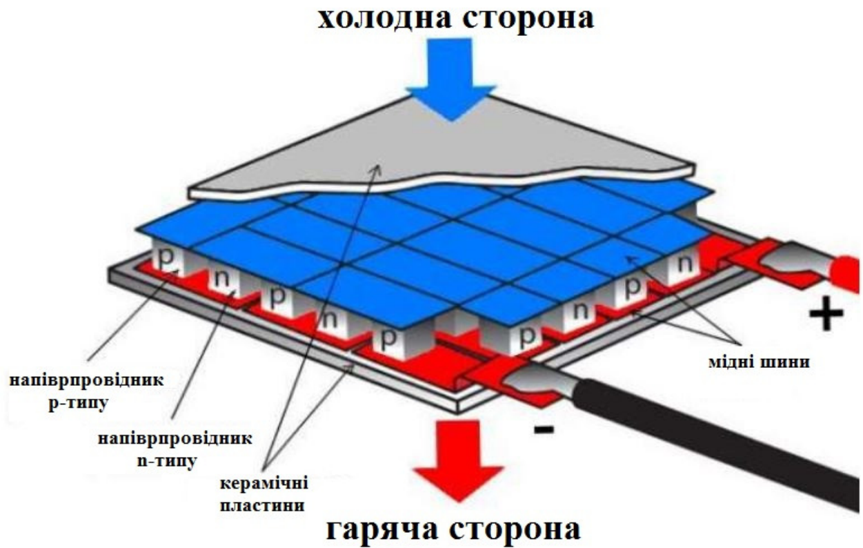
Рис. 1.4. Структура елемента Пельтьє
