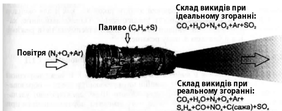
Рис. 6.1.1.1. Схема ідеального (теоретично повного) і реального згорання вуглеводневого палива в авіадвигунів
