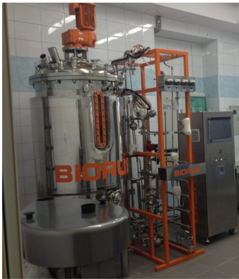
Рис. 3.1. Ферментер Biorus 700 L
