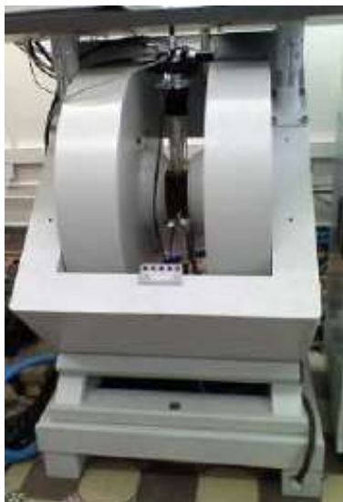
Рис. 4.3. Резистивний магніт з максимальним магнітним полем 1.4Т.
