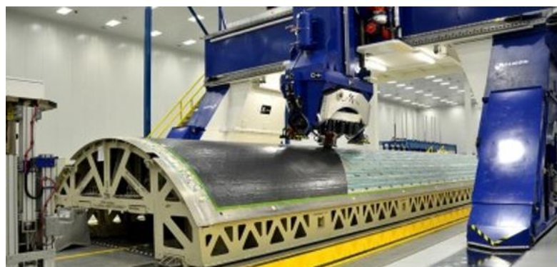
Рис 1.5. Покриття фюзеляжу полімером за допомогою АФР
