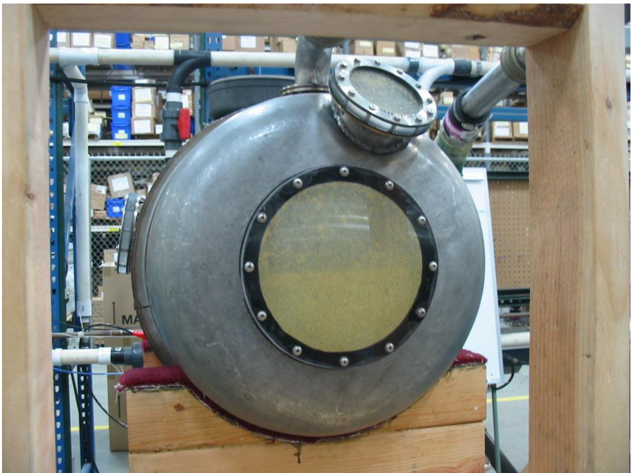
Рис. 5.3. Частково заповнений бак імітатором відходів.
