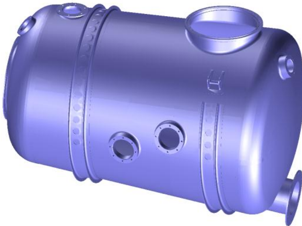
Рис. 4.6. Модель бака зберігання відходів літака Ан-148-100.
