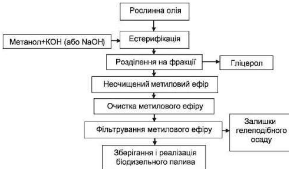
Рис. 2.5. Технічні етапи виробництва біодизельного палива
