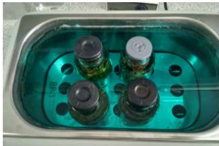
Рис. 2.3. Витримування екстрактів на водяній бані (водяна баня-термостат з перемішування WB-4MS)
