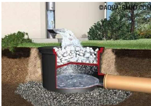
Рис. 7.1. Бак для збору дощової води, встановлений в ґрунт
