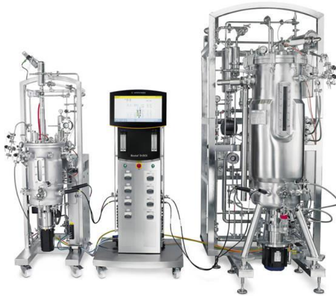
Рис. 2.2. Ферментер BIostat D-DCU для культивування дріжджів S.bouardii
