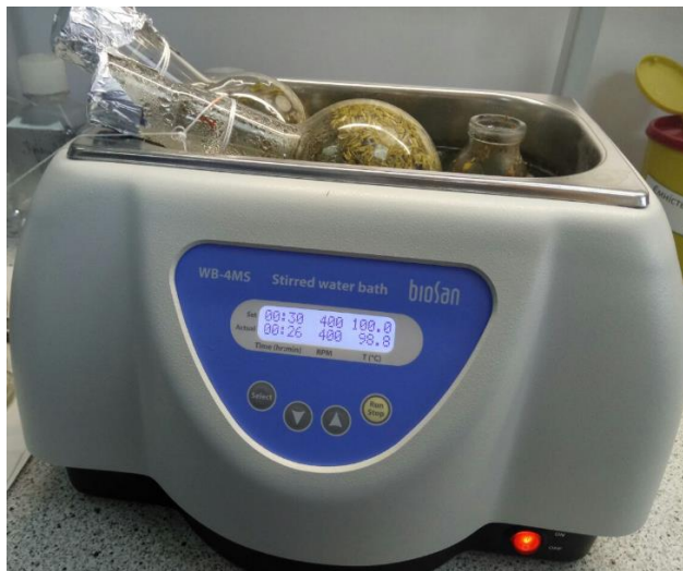
Мал. 2.4. Витримування екстрактів на водяній бані (WB-4MS)
