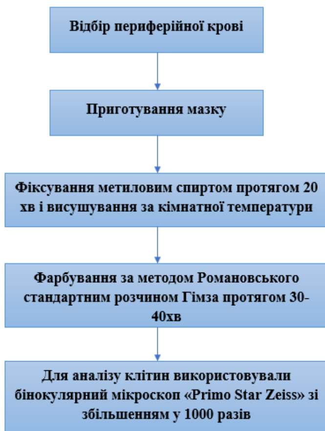
Рис. 2.2. Схема проведення мікроядерного тесту
