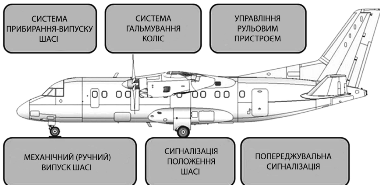
Рис. 2.1 Взаємодія шасі з системами літака
