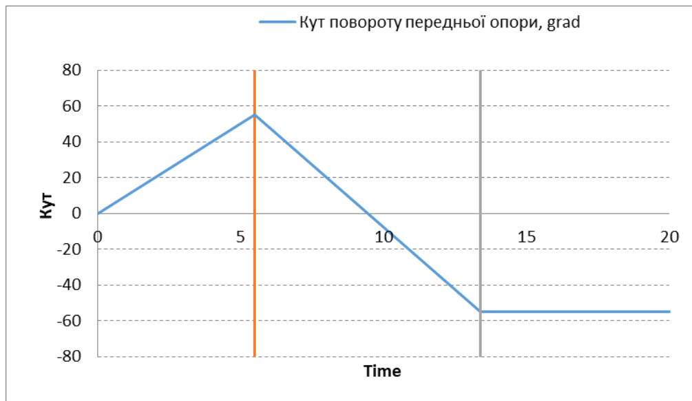
Рис. 2.16 Залежність кута повороту від часу без навантаження
