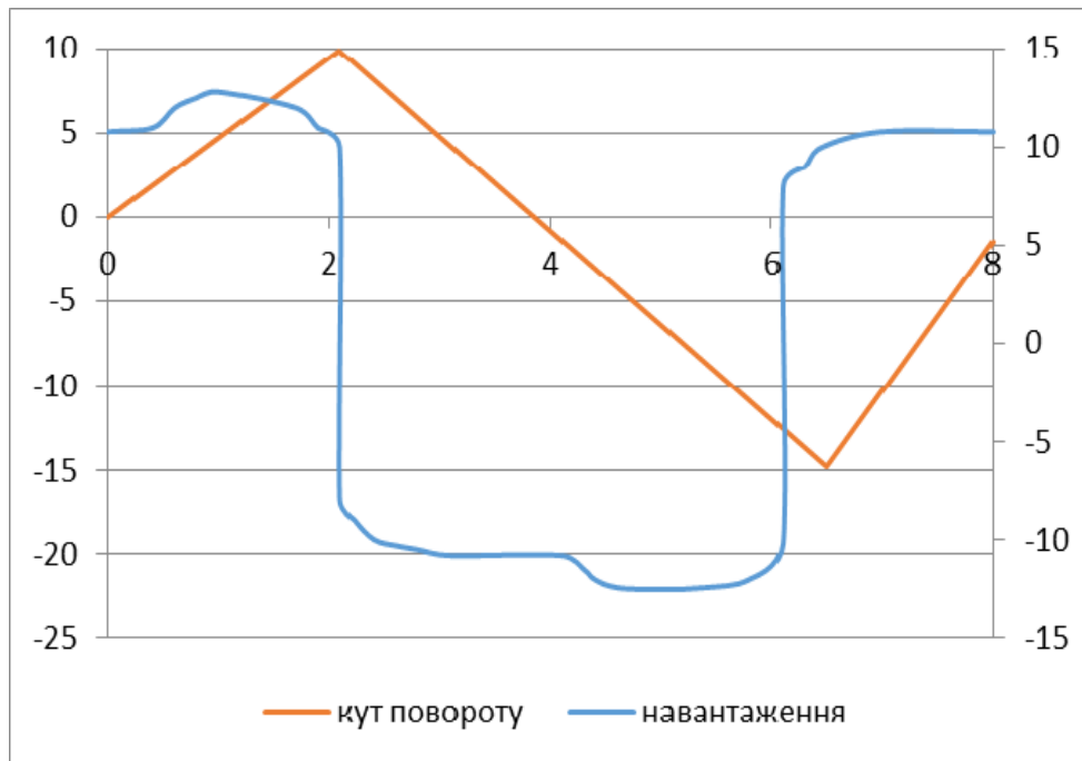
Рис. 2.22. Залежність навантаження та кута розвороту від часу
