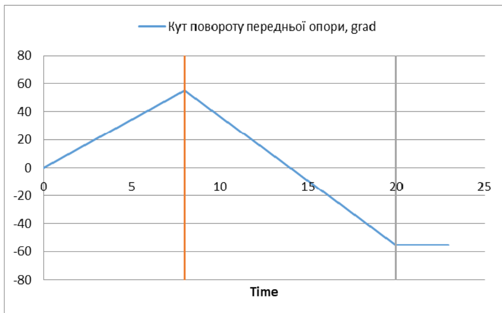
Рис. 2.17. Залежність кута повороту від часу із навантаженням
