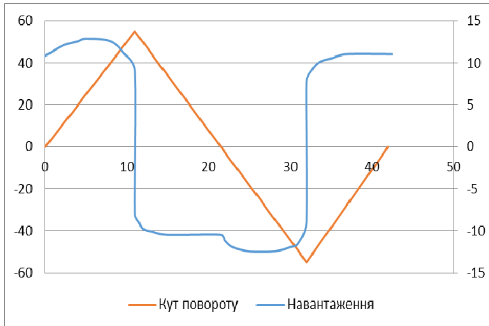
Рис. 2.20. Залежність навантаження та кута розвороту від часу
