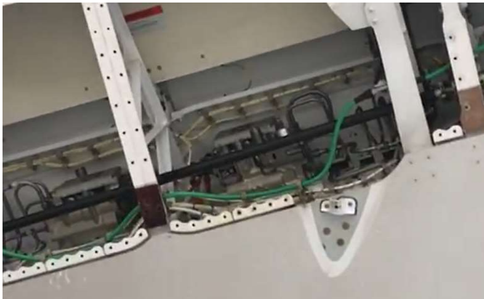
Рис 2.6 Вал з вуглепластику у складі приводу спойлерів літака Boeing 787
